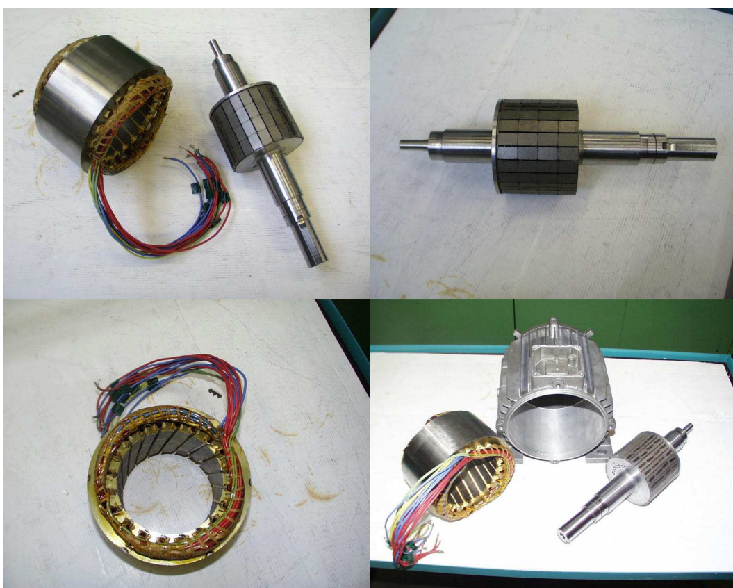
FIG. C.3 – Quelques photos de la machine pentaphasée expérimentale
